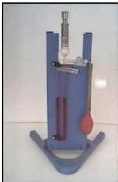
شكل (٢-١٥) صورة للجهاز بلين لتعين نعومة الأسمنت
